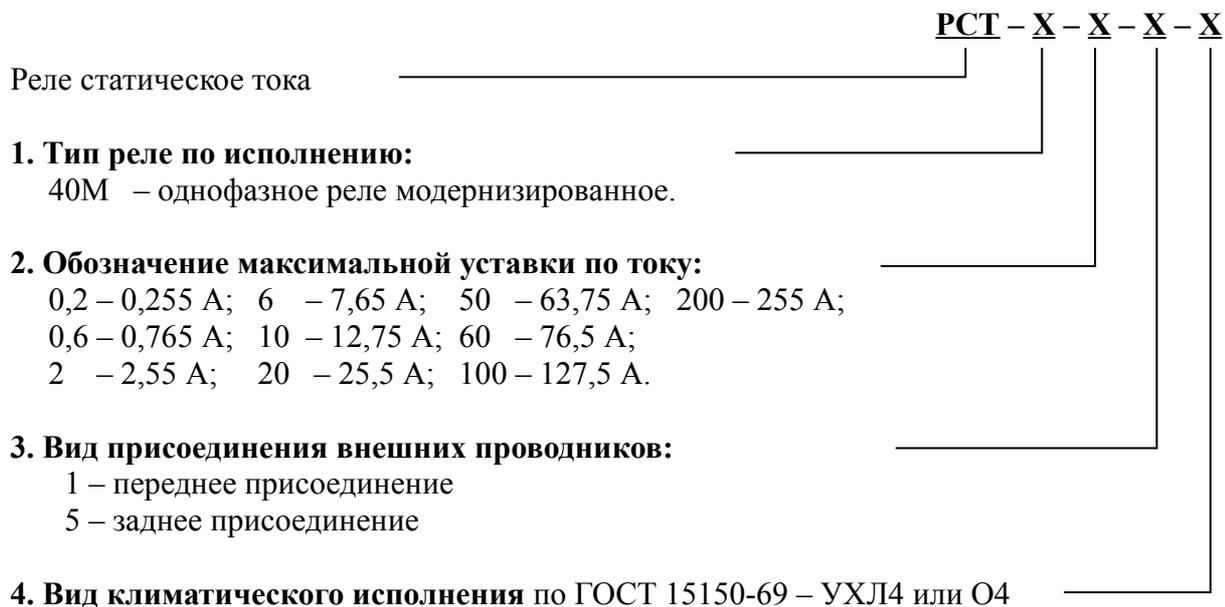
**Структура условного обозначения реле тока РСТ-40М1**
